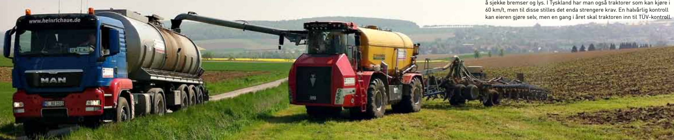
Fra tank til tank: Maskinstasjonen har fire gjødselsemier på 30 m 3 , som frakter biorest og husdyrgjødsel fra lager til jorden. Der venter Holmer-en, som suger gjødsel over i egen tank.
