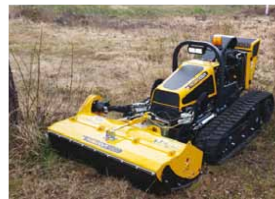
Fjernstyrt klipper – Robocut er en belte-maskin som går i opp til 55 grader helling alle veier.
