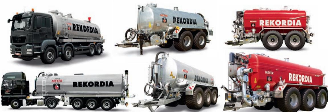
Von 10.000 bis 28.000 Liter Tankvolumen. Behälter aus Stahl verzinkt, Nirosta oder Kunststoff (GFK).
