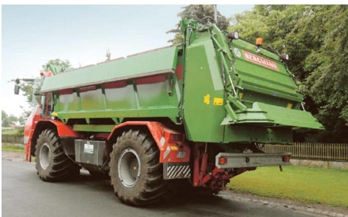
Über einen Wechselrahmen kann das Fass gegen einen Großflächenstreuer-Aufbau mit 33 Kubikmeter getauscht werden.
