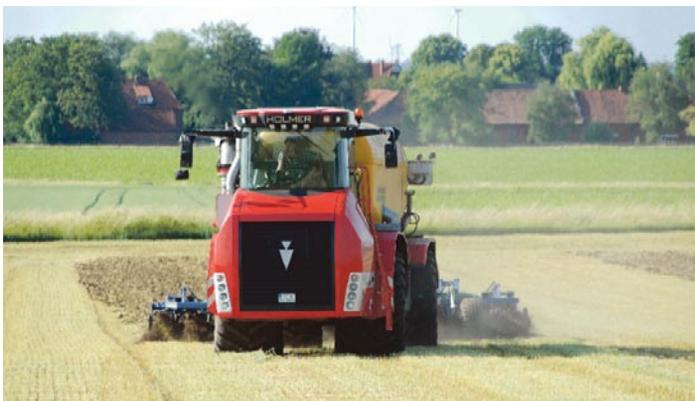
Die spurversetzte Fahrt im Hundegang minimiert den Bodendruck.
