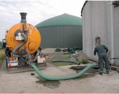
Heinrich Aue pumpt Gärreste aus der 680 kW Biogasanlage. Entfernung zum Feld ca. 5 km. Die Tankauflieger verfügen über eigene Pumptechnik mit einer Leistung von 4500- 6500 Liter/Minute
